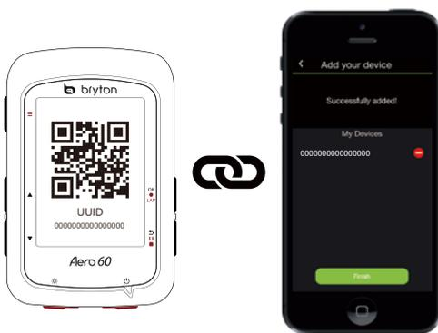
d. Si la asociación no se puede realizar, seleccione **Reintentar** para escanear o introducir de nuevo el número UUID de 16 dígitos que se encuentra en la parte posterior del dispositivo.
