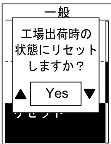
1. 設定メニューで、▼を押し、一般 > リセットを選択し、OK ● LAPを押します。
