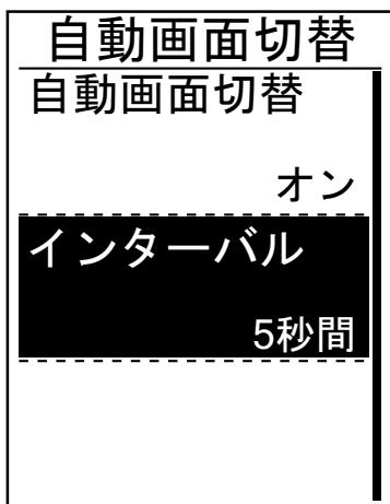
1. 設定メニューで▼を押し、一般 > **自動画面切替**を選択し、OK ● LAPを押します。
