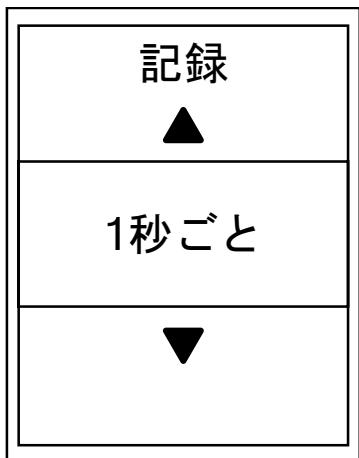
1. 設定メニューで、▼を押し、**計測** > **データ記録**を選択し、OK ● LAPを押します。
