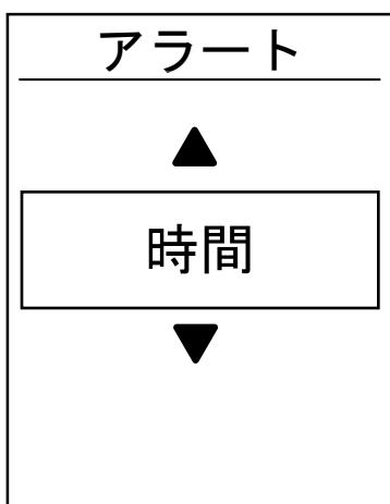
1. 設定メニューで、▼を押し、**計測 > アラート**を選択し、OK ● LAPを押して、そのサブメニューに入ります。
