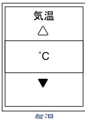
1. 設定メニューで▼を押し、一般>デバイス>時刻 / 単位>夏時間、日付表示、時刻表示、単位、気温を選択し、OK ● LAPを押します。
