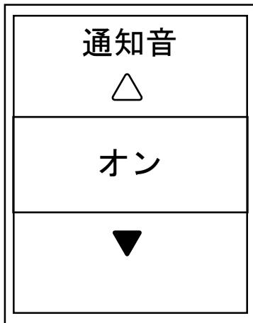
1. 設定メニューで▼を押し、一般>デバイス>通知音を選択し、を押します。
