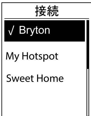
1. 設定メニューで、▼を押して、WLAN > 接続を選択し、OK ● LAP を押します。
