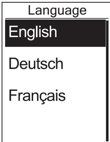
1. En el menú Config., pulse  $\nabla$  <sub>PAGE</sub> para seleccionar **Sistema > Language** y pulse  $\blacktriangleright$  <sub>LAP</sub>  $\bullet$  <sub>OK</sub>.
