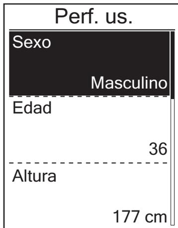
1. En el menú Config., pulse  $\nabla$  PAGE para seleccionar **Usuario** y pulse  $\begin{matrix} \text{LAP} \blacktriangleright \\ \text{OK} \end{matrix}$ .
