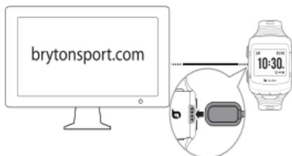
Mantenga el dispositivo conectado al PC para cargar la batería. Conecte el accesorio de carga USB al dispositivo y conecte el otro extremo a un PC.
